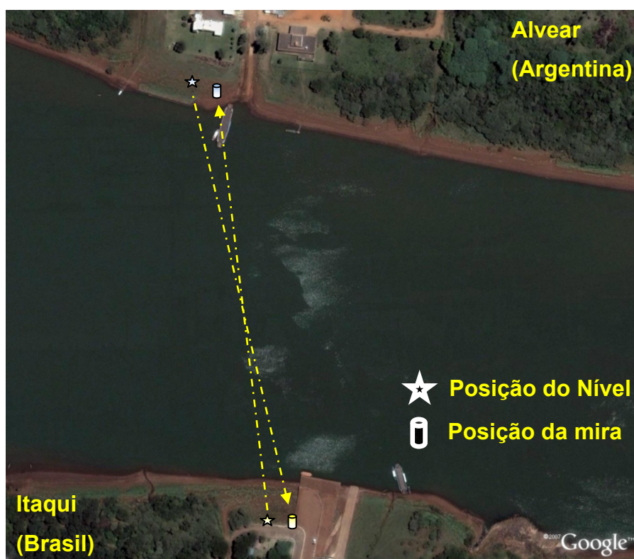
FIGURA 39 - ESQUEMA DO NIVELAMENTO DE TRAVESSIA. FONTE: Adaptado do GOOGLE EARTH™(2009).
