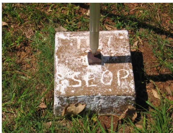
FIGURA 38 - MARCO VINCULADO AO NIVELAMENTO GNSS E TRIGONOMÉTRICO E SUPOSTAMENTE AO DE TRAVESSIA. FONTE: O Autor (2009).
