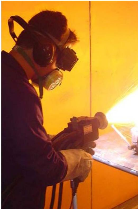
Figura 4.3. Deposição de uma liga Fe-Mn-Si por aspersão a arco ASP.
