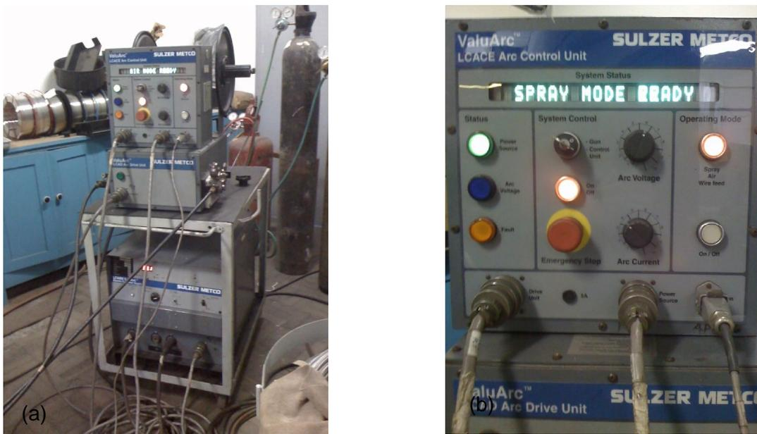
Figura 4.2. Equipamento de aspersão térmica ASP Suzler-Metco Value Arc 300E utilizado.
