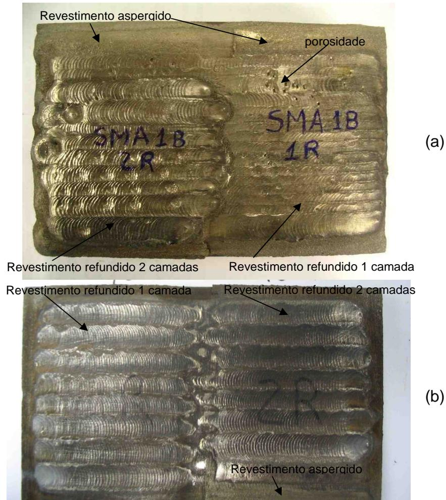
Figura 5.65. Aparência superficial dos revestimentos SMA\_Mn1 (a) e SMA\_Mn3 (b) após refusão por plasma PTA.
