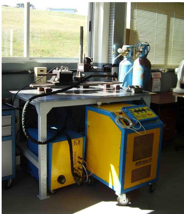
Figura 4.4. Processo de refusão por PTA das amostras aspergidas.
