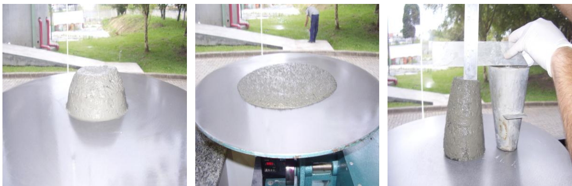
DF 14 - ENSAIOS DE ÍNDICE DE CONSISTÊNCIA E MINI SLUMP PARA A AMOSTRA A05. FONTE: O autor (2007)
