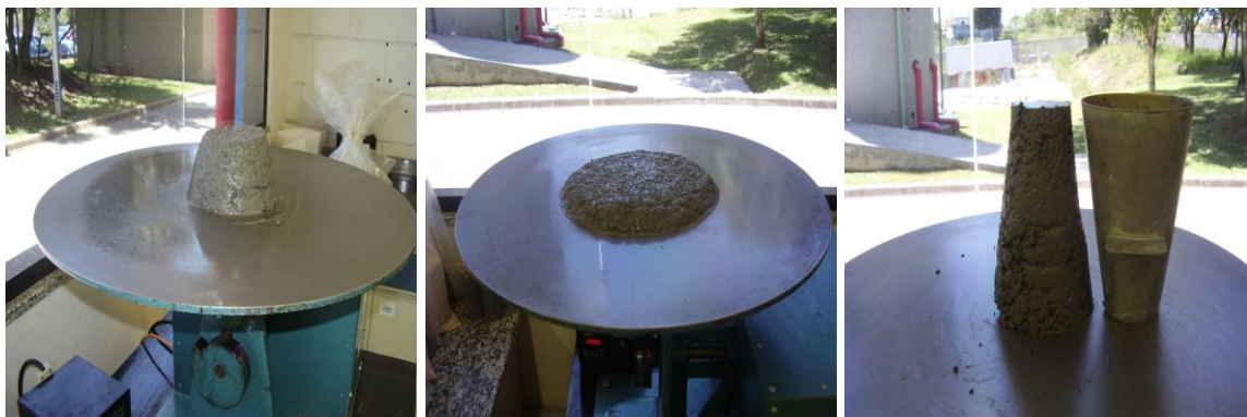
DF 19 - ENSAIOS DE ÍNDICE DE CONSISTÊNCIA E MINI SLUMP PARA A AMOSTRA B04.03. FONTE: O autor (2007)
