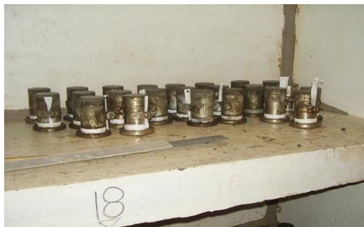
DF 6 - DETALHE DOS MOLDES NA CÂMARA ÚMIDA
