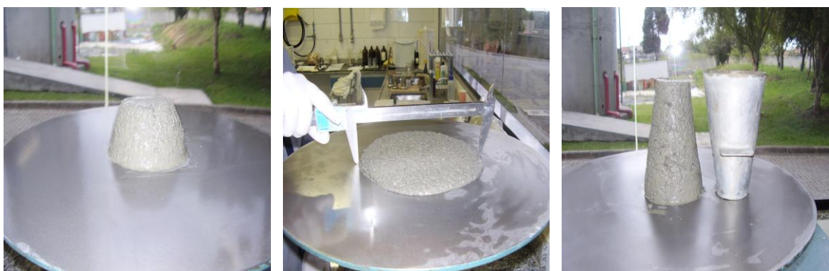
DF 15 - ENSAIOS DE ÍNDICE DE CONSISTÊNCIA E MINI SLUMP PARA A AMOSTRA A06. FONTE: O autor (2007)
