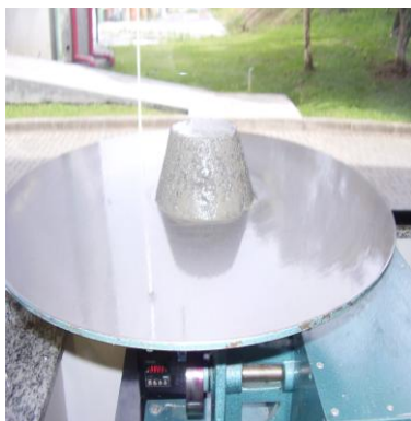
DF 12 - ENSAIOS DE ÍNDICE DE CONSISTÊNCIA E MINI SLUMP PARA A AMOSTRA A03. FONTE: O autor (2007)
