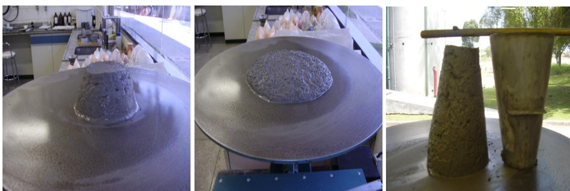
DF 29 - ENSAIOS DE ÍNDICE DE CONSISTÊNCIA E MINI SLUMP PARA A AMOSTRA B06.09. FONTE: O autor (2007)
