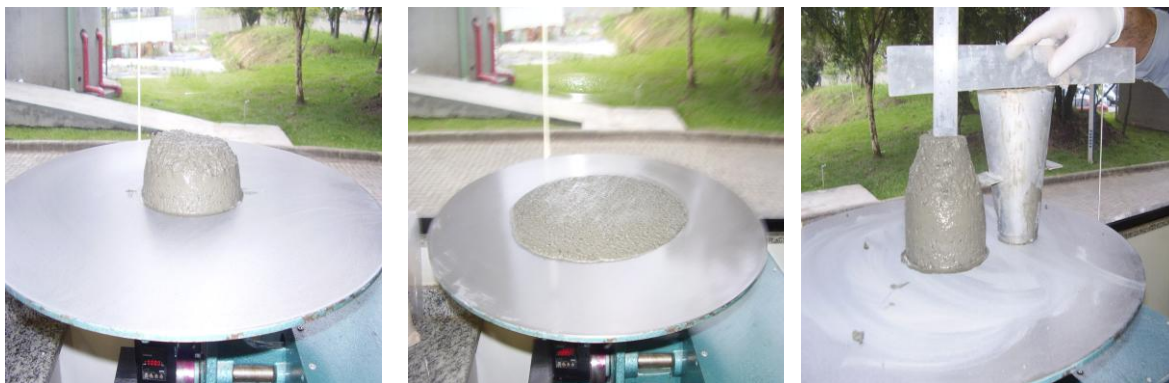
DF 16 - ENSAIOS DE ÍNDICE DE CONSISTÊNCIA E MINI SLUMP PARA A AMOSTRA A07. FONTE: O autor (2007)
