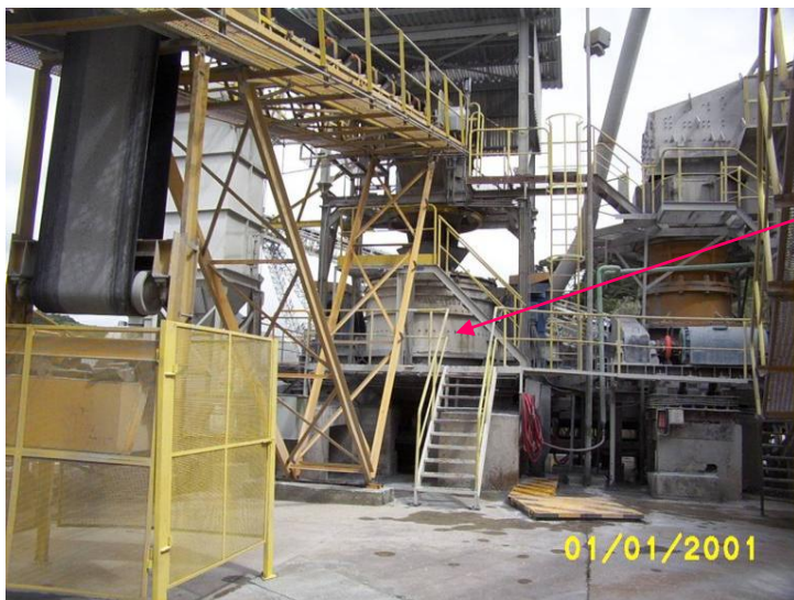
FIGURA 7 - DETALHE DO BRITADOR CANICA VSI 155. FONTE: Votorantim.
