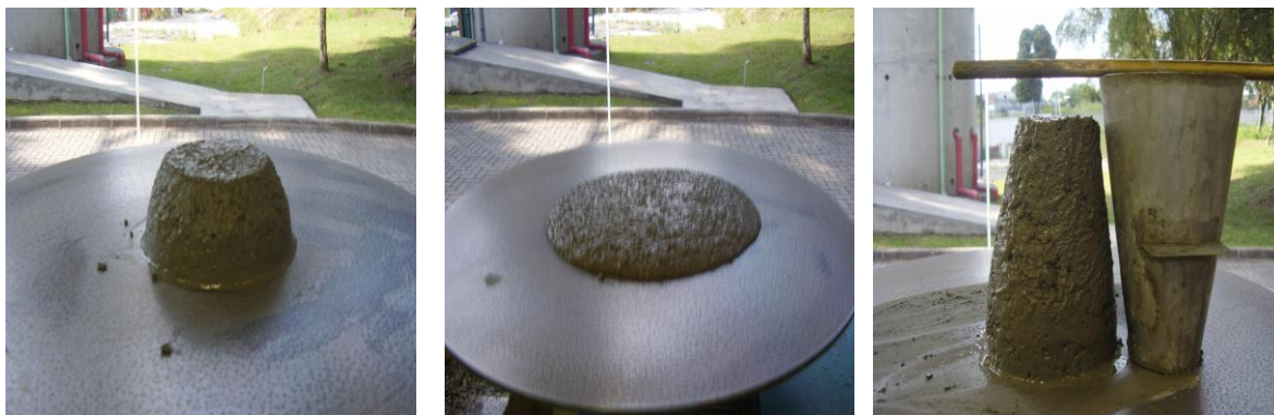
DF 27 - ENSAIOS DE ÍNDICE DE CONSISTÊNCIA E MINI SLUMP PARA A AMOSTRA B06.03. FONTE: O autor (2007)
