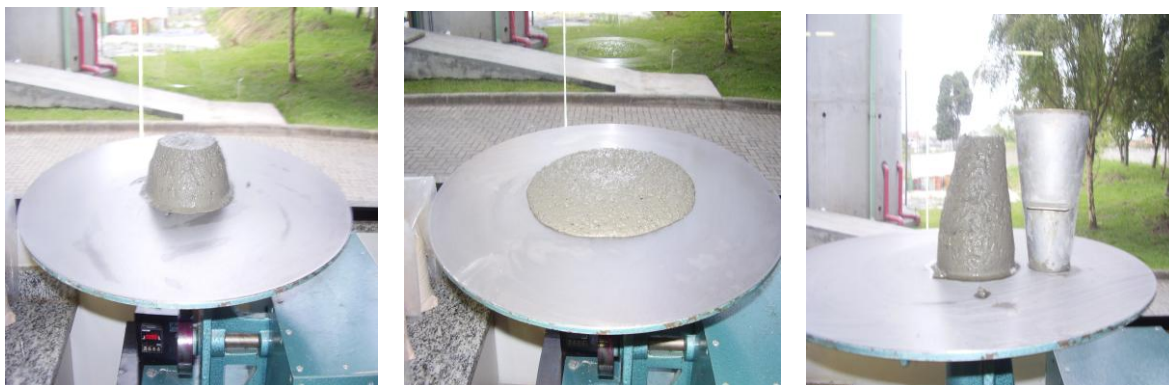
DF 13 - ENSAIOS DE ÍNDICE DE CONSISTÊNCIA E MINI SLUMP PARA A AMOSTRA A04. FONTE: O autor (2007)
