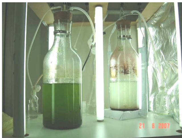
FIGURA 16: Fotobioreator vertical utilizado para cultivo de H. pluvialis
