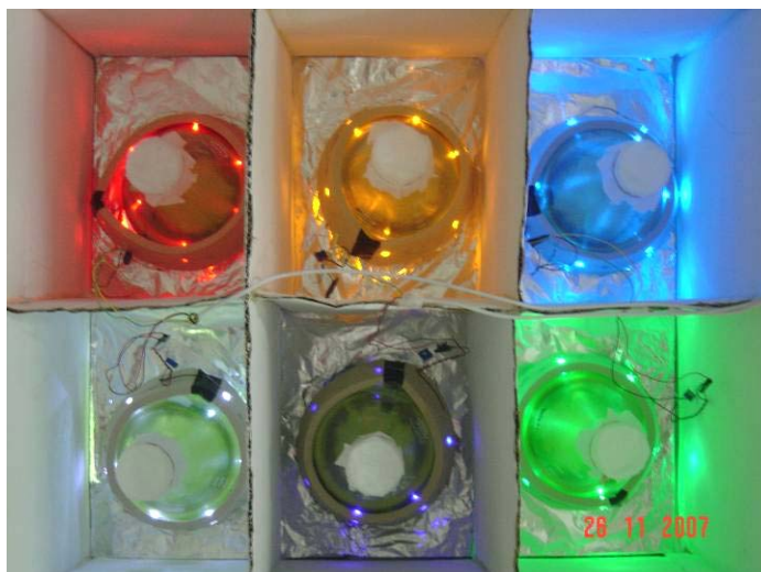
FIGURA 17: Cultivo de H. pluvialis em erlenmeyers, com LEDs de diferentes cores.
