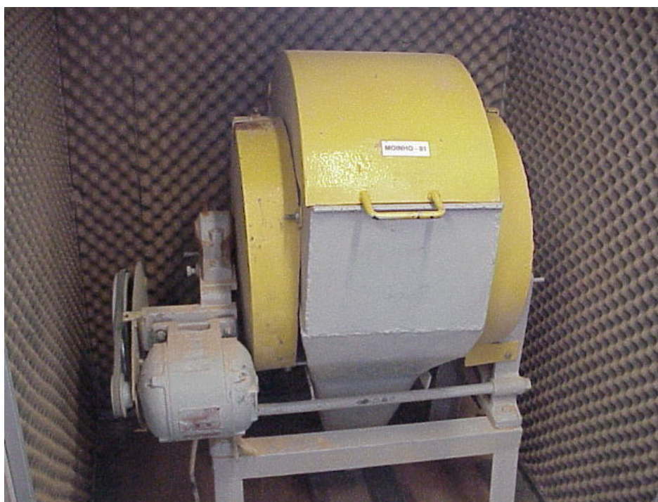
Figura 6 – Moinho de bolas utilizado para moagem das argilas.
