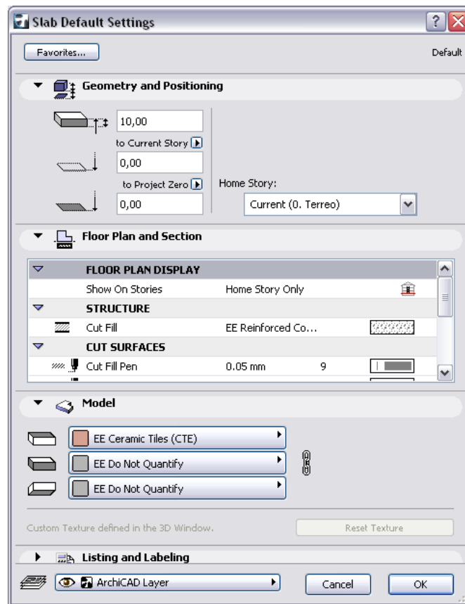
Fig. 4.22: janela de configuração dos parâmetros de um objeto representando uma laje.
