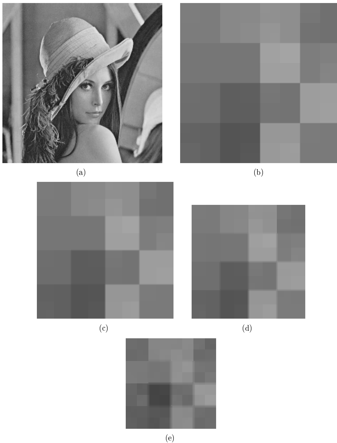
Figura 4.130: Imagens comprimidas com quadtree com GLS e modelo 2T: (a) imagem da Lenna com 512 \times 512 pixels original; (b) imagem da Lenna com 512 \times 512 pixels comprimida. (c) imagem Lenna com 256 \times 256 pixels comprimida; (d) imagem Lenna com 128 \times 128 pixels comprimida; (e) imagem Lenna com 64 \times 64 pixels comprimida.
