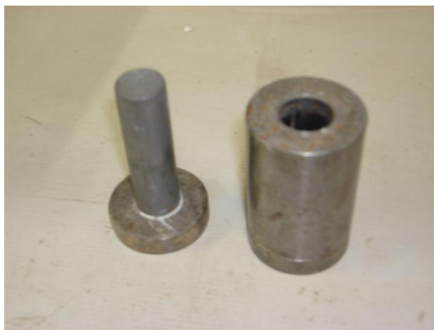
FIGURA 3.5 – MOLDE DE AÇO PARA CONFECÇÃO DOS CORPOS DE PROVA
