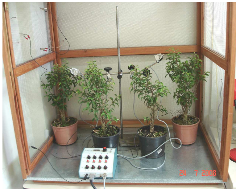
Figura 1. Equipamento GIGA 4 – DC, com quatro canais, para a avaliação simultânea do comportamento alimentar de quatro fêmeas partenogenéticas de G. ficicola , dispostas sobre mudas de F. benjamina , dentro de uma Gaiola de Faraday.
