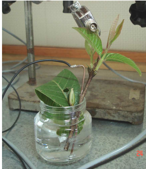
Figura 2. Brotos de P. guajava (15 cm) utilizados nos experimentos do comportamento alimentar de G. psidii , pelo monitoramento eletrônico EPG, utilizando o equipamento GIGA 4 – DC.
