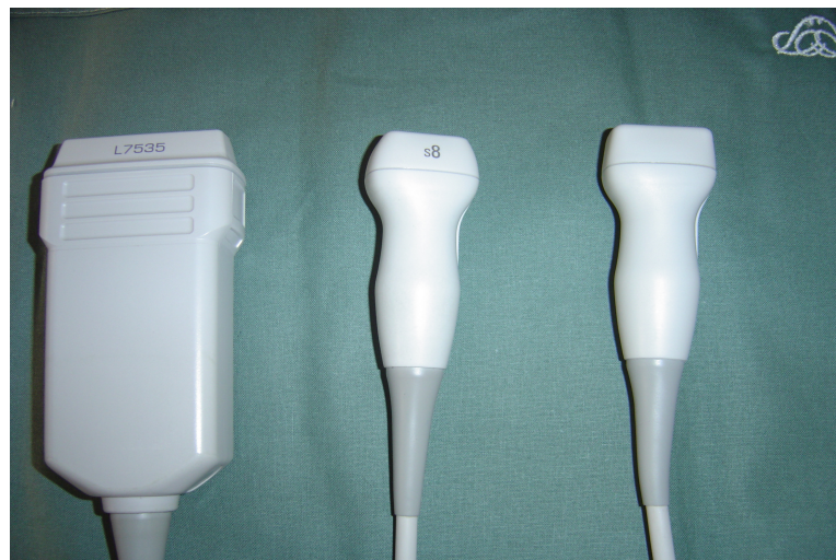
FIGURA 2 - TRANSDUTORES DA ESQUERDA PARA DIREITA LINEAR COM 4 A 7,5 MHZ, SETORIAL S8 3 A 8 MHZ E SETORIAL 2 A 4 MHZ.
