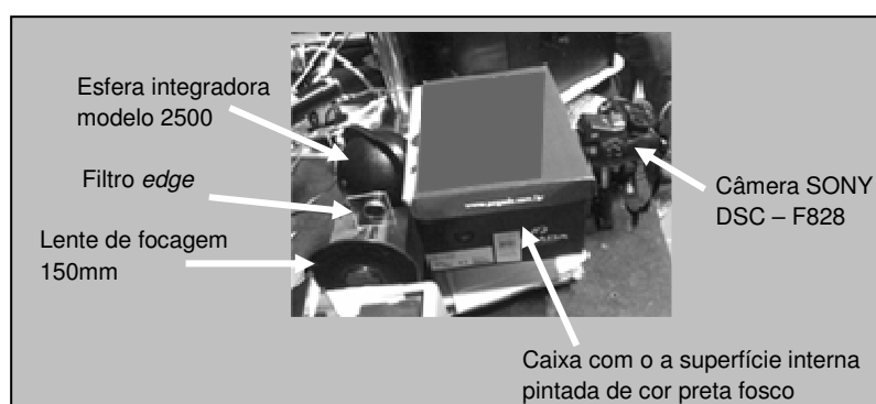
FIGURA 46: MONTAGEM DO SISTEMA PARA A OBTENÇÃO DOS DADOS PARA AVERIGUAR A REGIÃO DE ATUAÇÃO DO FILTRO DE CORTE INFRAVERMELHO, ASSIM COMO DA GRADE DE FILTRO DE COR DO CCD.
