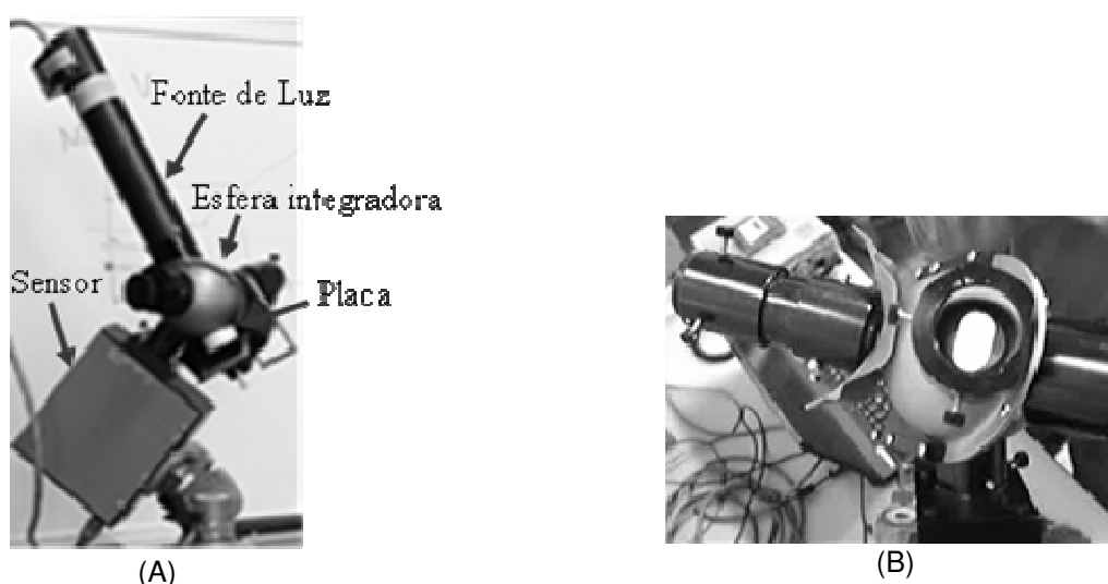
FIGURA 23 – (A) ESFERA INTEGRADORA COM A FONTE DE LUZ DIRECIONADA SOBRE A PLACA PADRÃO. (B) ILUMINAÇÃO REFLETIDA PELA FOLHA E ESPALHADA PELA ESFERA INTEGRADORA.
