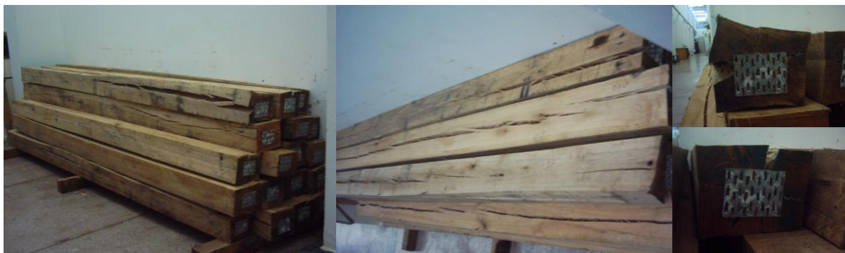
FIGURA 10 – FENDAS E RACHADURAS APRESENTADAS PELOS CORPOS DE PROVA CONFECCIONADOS COM A ESPÉCIE Eucalyptus dunnii
