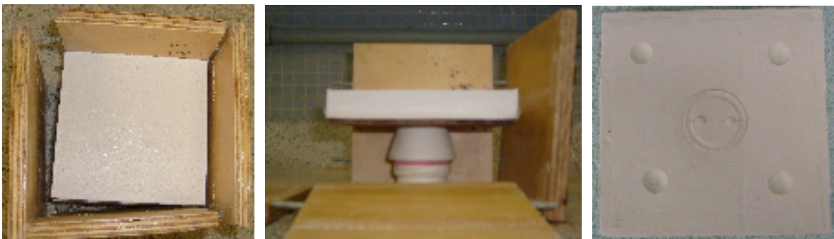
Figura 34 – Caixa sendo aberta para retirada do molde de gesso e molde pronto. FONTE: A autora (2008)
