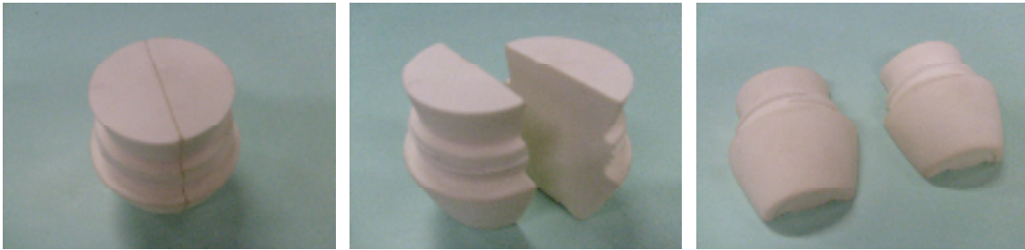
Figura 29 – Modelo feito em PU através de prototipagem. FONTE: A autora (2008)
