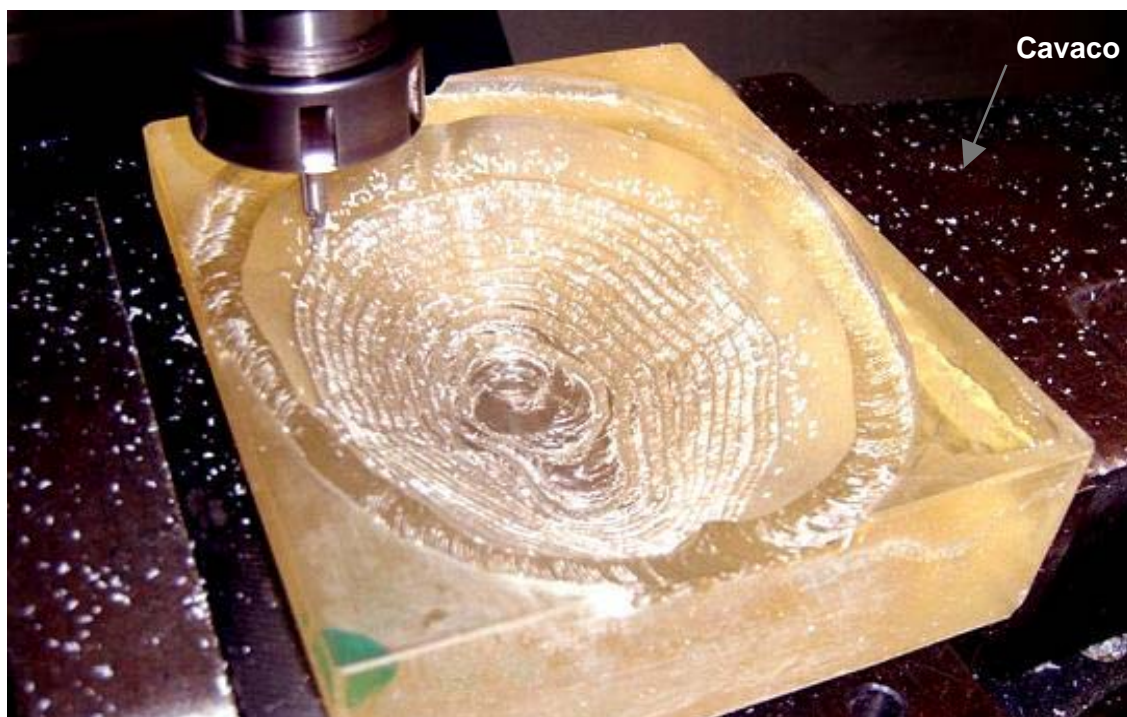
Figura 60 – Primeira etapa de acabamento da superfície interna, com estratégia de “Z constante”.
