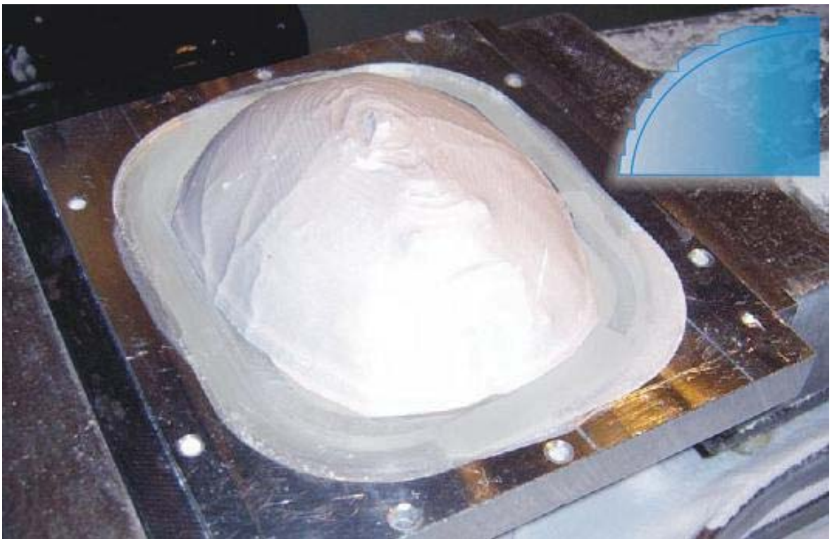
Figura 50 - Resultado da segunda operação de desbaste no contorno, desfazendo os degraus e deixando 0,5mm de sobre-material.
