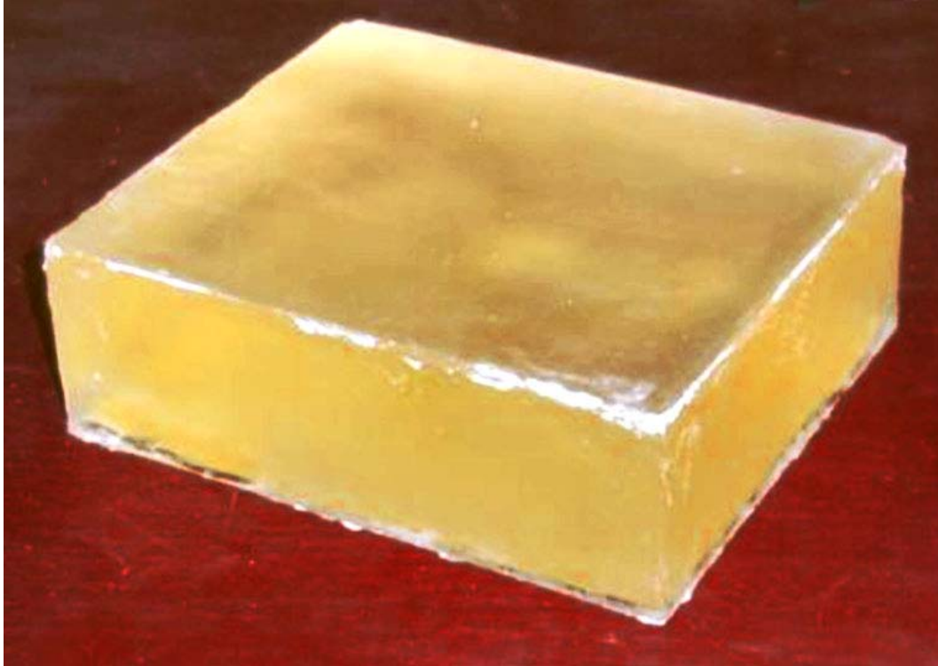
Figura 55 – Bloco de PMMA polimerizado e desmoldado.
