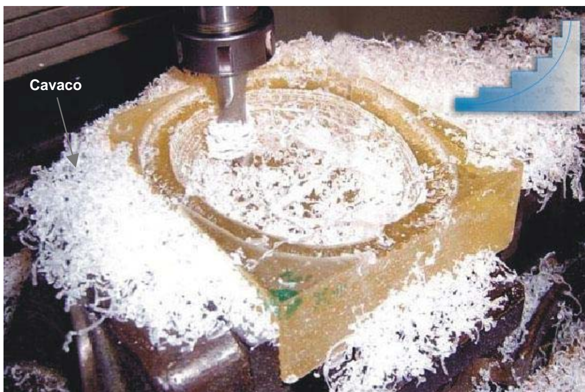
Figura 58 – Primeira etapa de desbaste da superfície interna. Detalhe ao cavaco obtido.
