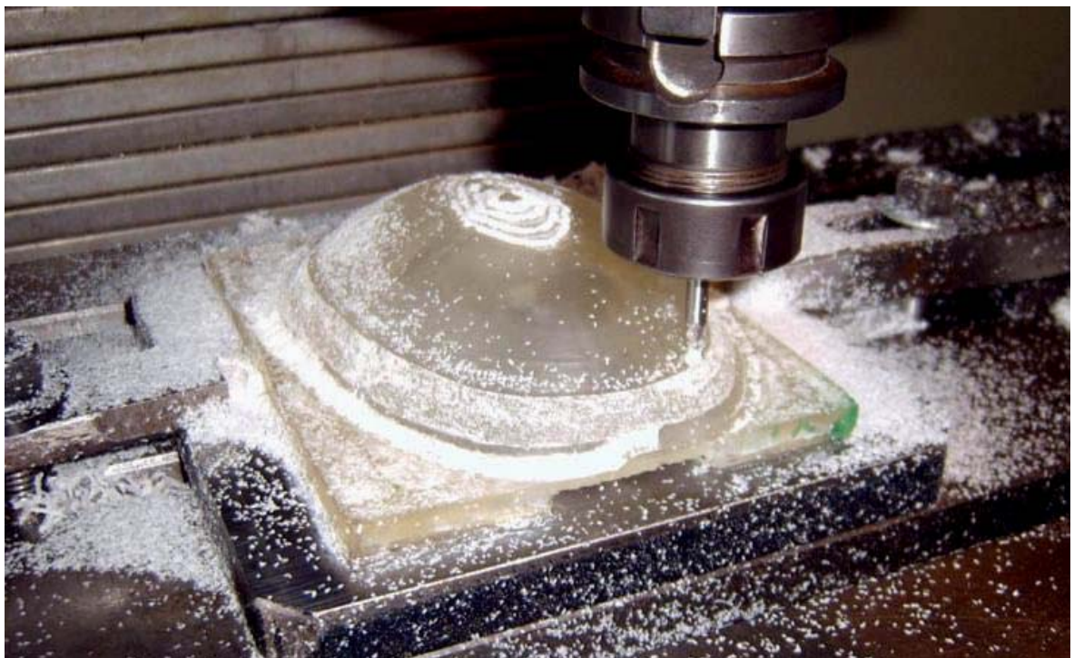
Figura 64 – Primeira etapa de acabamento da superfície externa com estratégia de “Z constante”.
