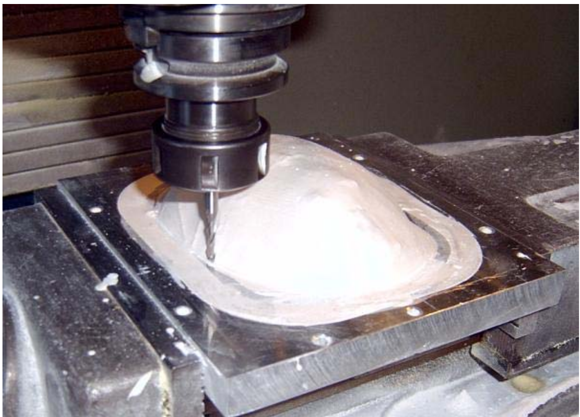
Figura 53 - Terceira etapa de usinagem do acabamento com fresa de topo reto
