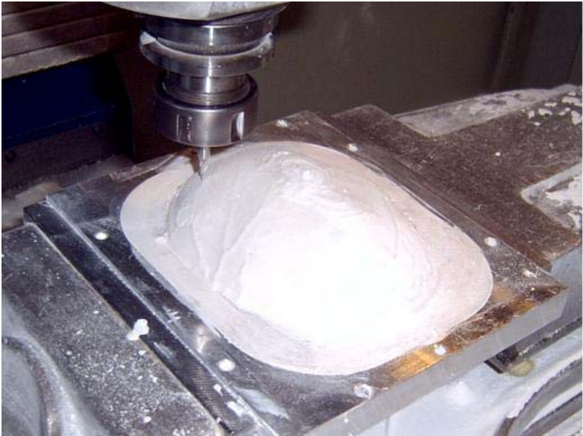
Figura 51 – Resultado da primeira etapa de acabamento com estratégia de “Z constante”.
