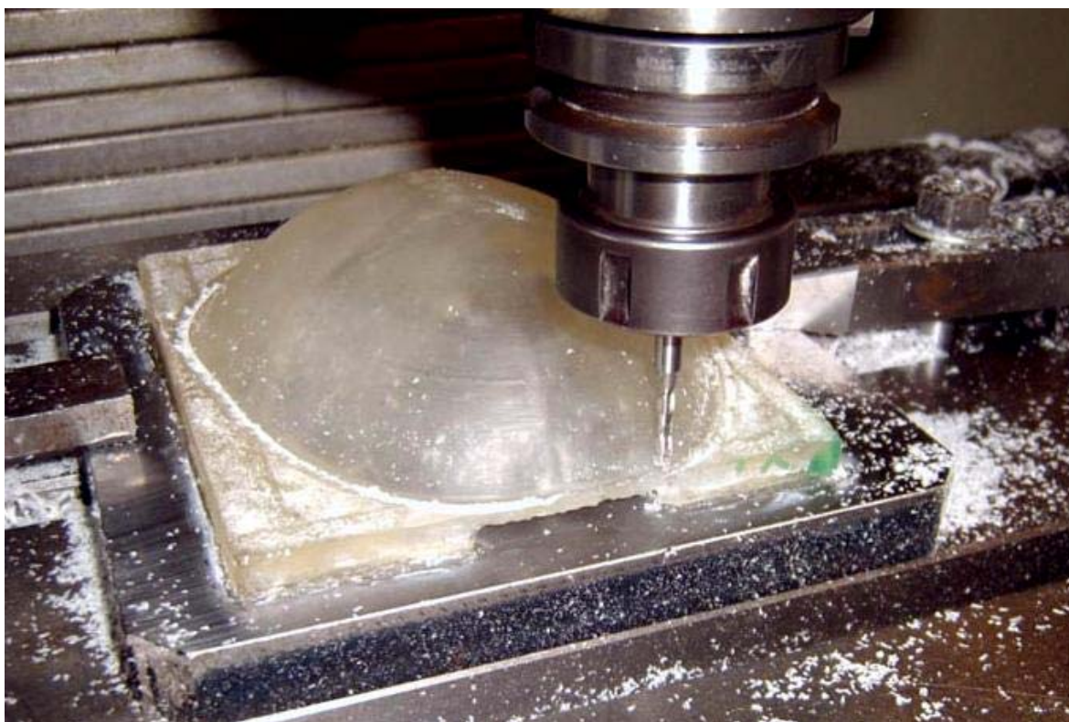
Figura 66 - Terceira etapa de acabamento para desprendimento da possível prótese do restante do bloco, estratégia de “Z constante” com ferramenta de topo reto.
