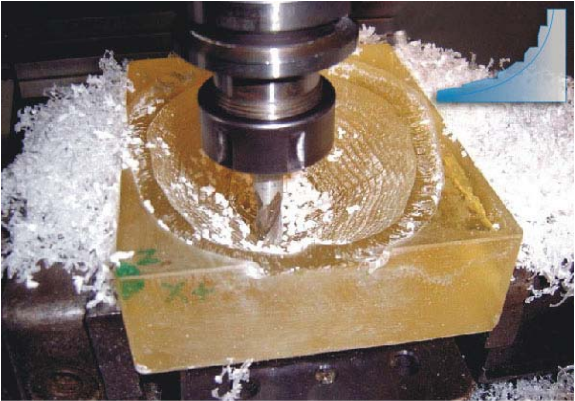
Figura 59 – Segunda etapa do desbaste no contorno, com suavização dos degraus e 0,5mm de sobre-material.
