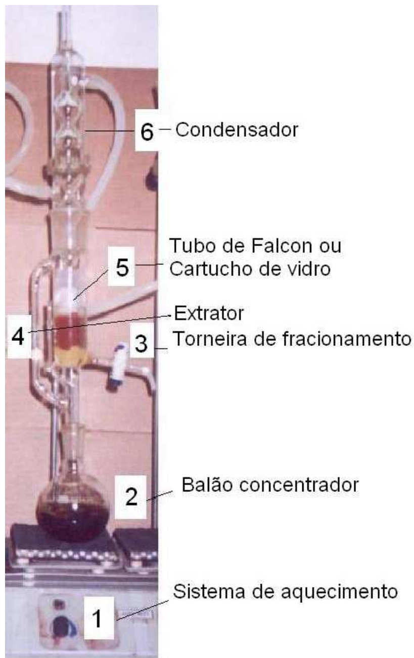
FIGURA 4 – APARELHO SOXHLET ANALÍTICO
