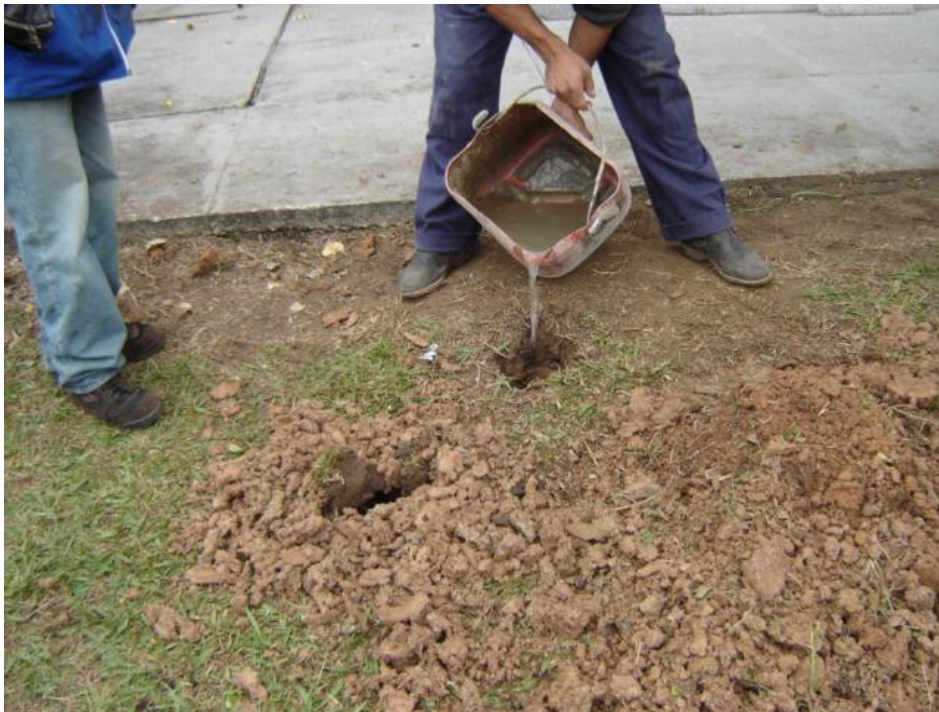
FIGURA 10 - PREENCHIMENTO DAS COVAS CILÍNDRICAS COM ÁGUA NOTA: Realizado em 05/2006
