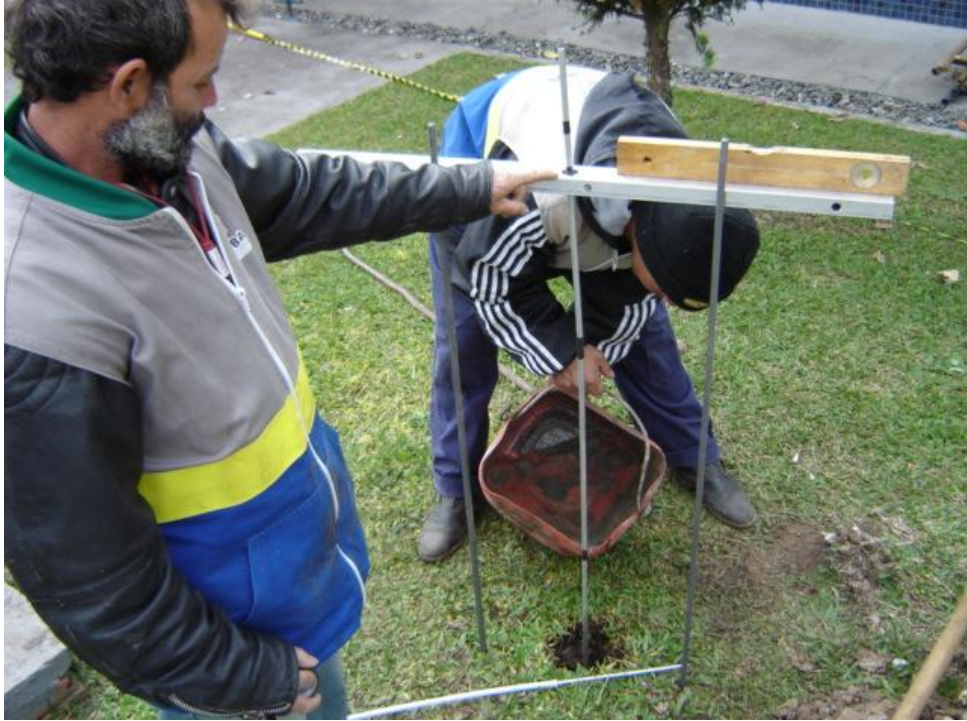
FIGURA 13 - DETALHE DO ENCHIMENTO DA COVA CILÍNDRICA NOTA: Realizado em 05/2006
