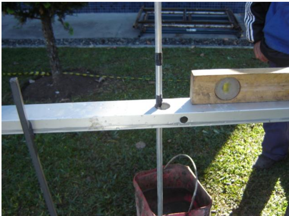
FIGURA 14: DETALHE DO VÃO DE 5,1 CM MARCADO NA HASTE DE BÓIA PARA FACILITAR A MEDIÇÃO NOTA: Realizado em 05/2006
