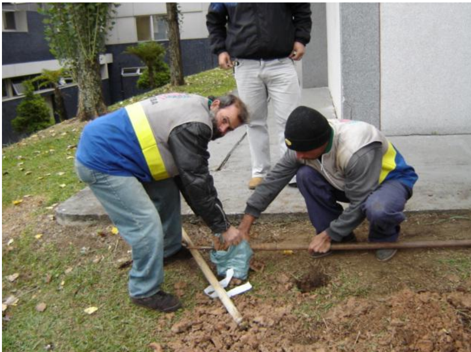
FIGURA 15 - DETALHE DA COLETA DE AMOSTRA DE SOLO PARA POSTERIOR ENSAIO EM LABORATÓRIO
