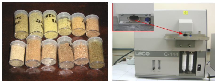
FIGURA 7: AMOSTRAS PRONTAS PARA ANÁLISE E O ANALISADOR DE CARBONO LECO C-144
