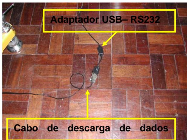
FIGURA 4.8 – Ligação do cabo da estação com o adaptador USB-Serial
