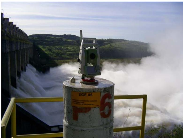
FIGURA 1.2 - Estação total robotizada TCRA1205
