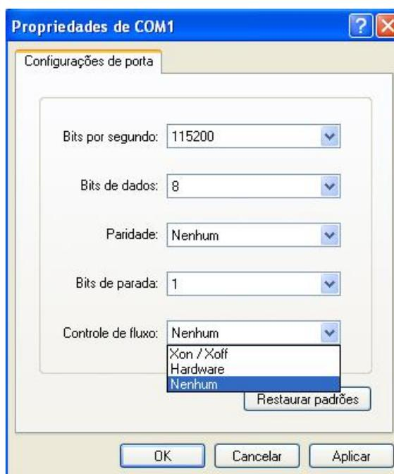
FIGURA 4.7 – Configurações de comunicação de uma porta serial
