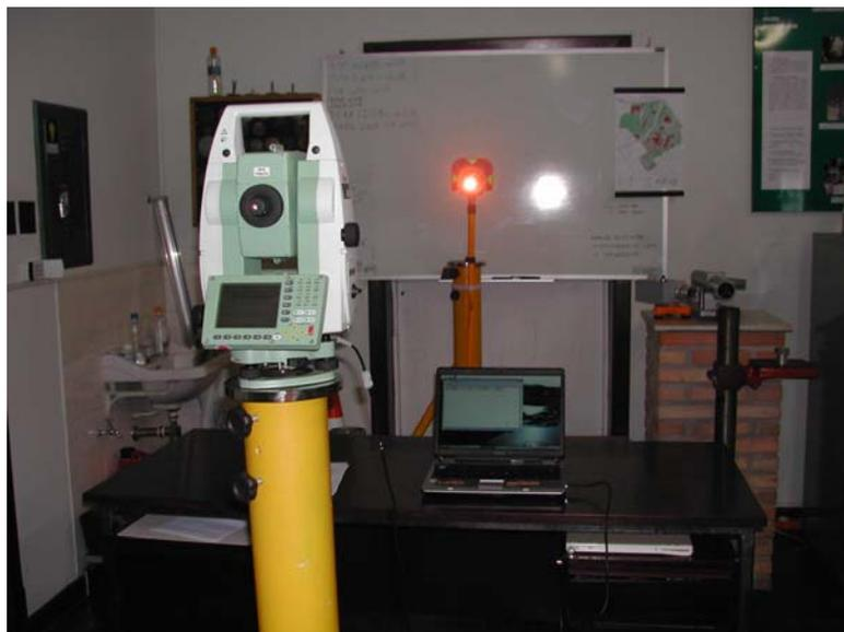
FIGURA 4.14 – Experimento de Recepção de dados via cabo usando o *HyperTerminal*
