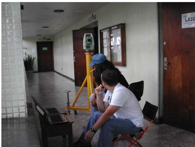
FIGURA 4.22 – Experimento de recepção de dados via *Bluetooth*<sup>®</sup> usando o *HyperTerminal*.
