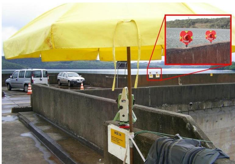
FIGURA 3.14 – Prismas posicionados em pontos a montante.
