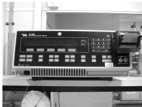
**FIGURA 13 – ANALISADOR DE IMPEDÂNCIA SOLARTRON (SI 1260).**
