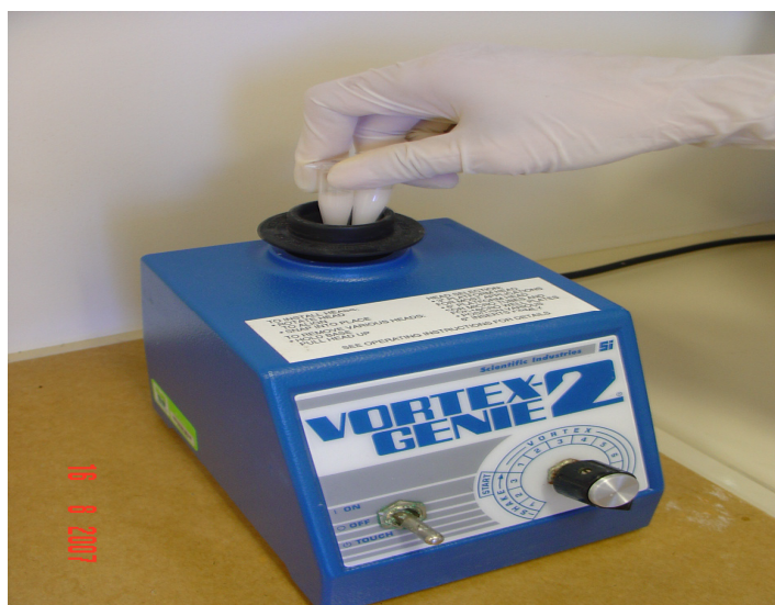
FIGURA 10 – AGITADOR VORTEX GENIE 2
