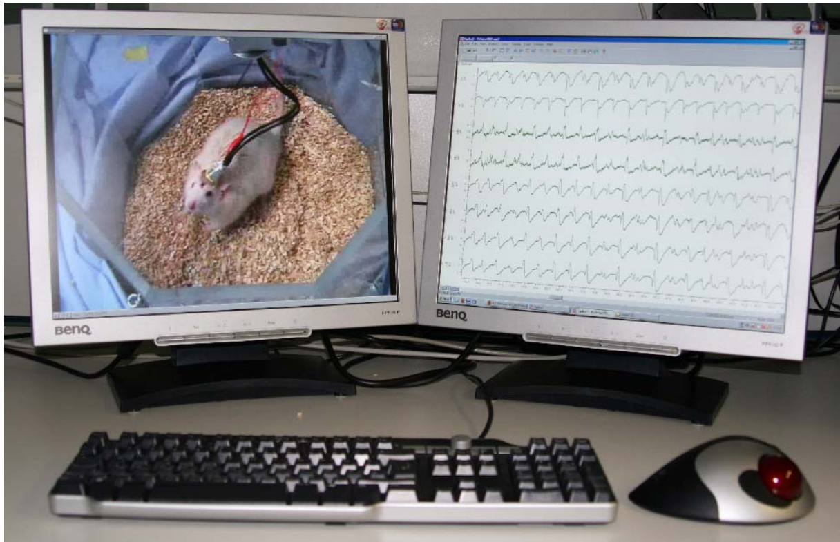
FIGURA 13 – FOTOGRAFIA DO SISTEMA DE REGISTRO SIMULTÂNEO DO TRAÇADO DE EEGI E PADRÃO COMPORTAMENTAL.
