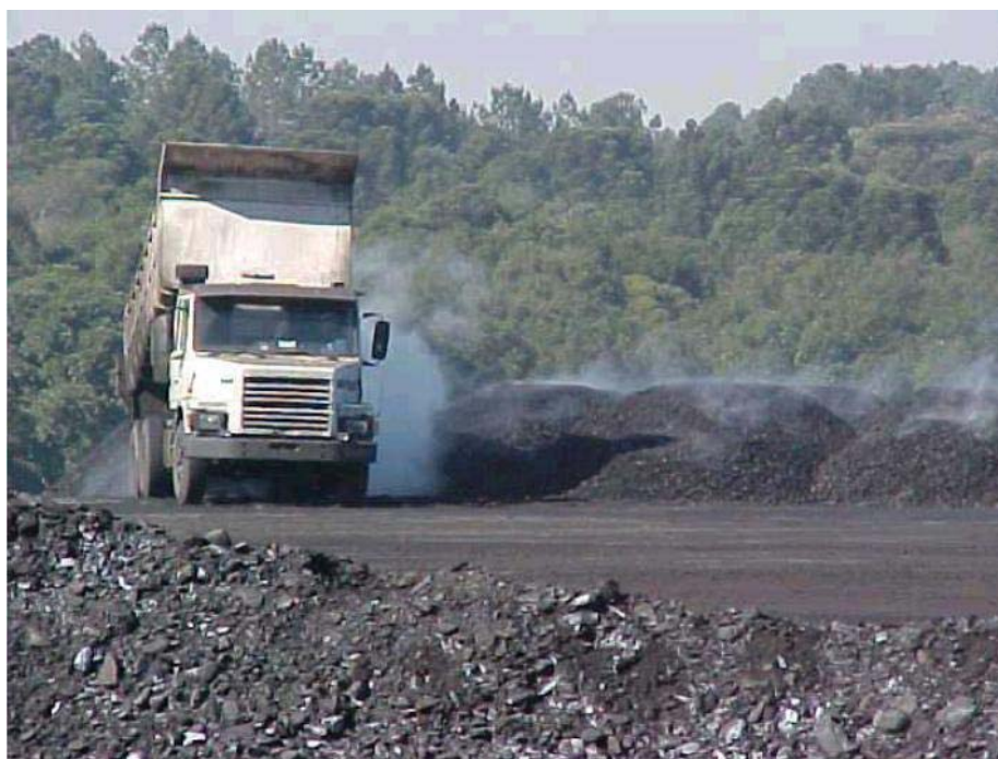
FIGURA 6. DEPOSIÇÃO DE SUBPRODUTO SÓLIDO DE PROCESSO INDUSTRIAL (SSPI) PROVENIENTE DO PROCESSO PETROSIX (SIX, 2006).
