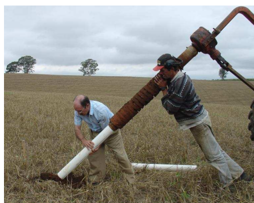
RETIRADA DO TUBO (MONÓLITO)
